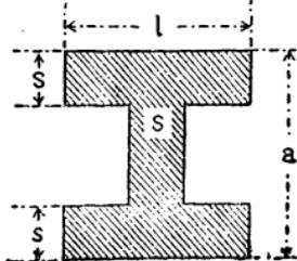
113. Si calcoli l'area della sezione di una trave in ferro a doppio T, posto che le dimensioni siano (vedi figura dove  $a$  indica l'altezza,  $l$  la larghezza delle ali,  $s$  lo spessore dell'anima,  $s_1$  lo spessore delle ali):
