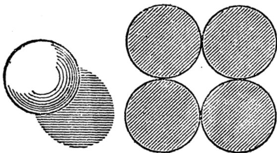
Preso una sfera di lamiera, p. es. di ottone, si ritagliano da una lamina piana di ottone di identico spessore quattro dischi circolari di diametro uguale a quello della sfera. Ponendo sui piatti di una bilancia da una parte la sfera e dall'altra i quattro dischi, si verifica che i due pesi sono esattamente uguali: co-
