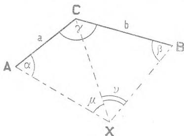
Qui i dati sono le distanze  $a = AC$ ,  $b = BC$ , l'angolo  $\gamma = \widehat{ACB}$  e infine gli angoli  $\mu$  e  $\nu$  sotto cui codeste due distanze sono viste dal punto  $X$ , che supponiamo, come si suole, interno all'angolo convesso (cioè minore di  $180^\circ$ )  $\widehat{ACB}$ . Il punto  $X$  è manifestamente l'intersezione dei due archi circolari, di corde  $AC$ ,  $BC$ , capaci dell'angolo, rispettivamente,  $\mu$  e  $\nu$ .
