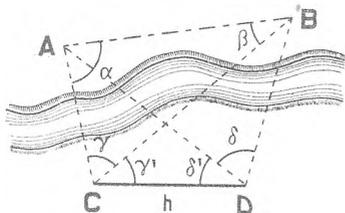
Così per ciascuno dei triangoli  $BCD, ACD$  si conoscono un lato e i due angoli adiacenti. Risolvendo i due triangoli (n. 163) si determineranno le distanze  $CB, CA$ ; dopo di che, risolvendo il triangolo  $ABC$ , del quale sono noti oramai due lati e l'angolo compreso (n. 152) si calcherà la distanza cercata  $AB$ .
