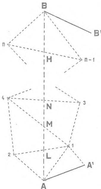
Si ripetono le misure e il calcolo per il triangolo  $A12$ ; e così via di seguito, partendo ogni volta dai risultati ottenuti nella risoluzione del triangolo precedente. Siccome la direzione del meridiano  $AB$  è nota, si determinano così successivamente le lunghezze  $AL$ ,  $LM$ , ...,  $HB$ , e la somma di queste fornisce la lunghezza cercata di  $AB$ .
