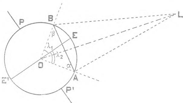
calcolare, risolvendo il triangolo  $AOB$ , del quale si conoscono i lati  $OA$ ,  $OB$ , come raggi terrestri corrispondenti a latitudini note, e l'angolo  $\widehat{AOB}$  che (nel caso della figura, in cui  $A$  e  $B$  sono da parti opposte dell'equatore  $EE'$ ) è dato dalla somma  $\lambda_1 + \lambda_2$  delle latitudini di  $A$  e  $B$ .
