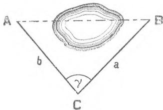
Scelto un punto  $C$ , da cui  $A$  e  $B$  siano visibili, si misuri l'angolo  $\gamma$ , sotto cui è vista da  $C$  la distanza incognita  $AB$ , e si misurino direttamente le distanze  $a = CB$ ,  $b = AC$ . Risolvendo, secondo il n. 152, il trian-
