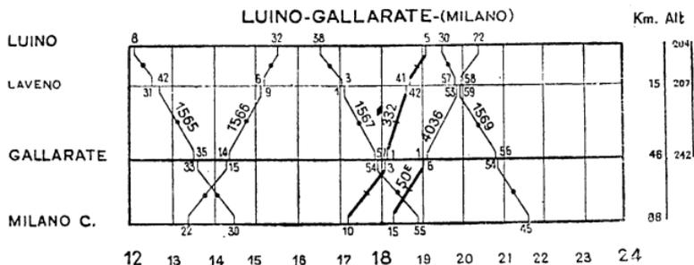
Luino-Milano tra le 12<sup>h</sup> e le 24<sup>h</sup>. I tratti più marcati corrispondono a diretti, quelli più lievi e con un punto ad accelerati. Le distanze chilometriche non sono rappresentate in scala, ma indicate numericamente a destra del diagramma, insieme con le altitudini sul livello del mare (in metri).
